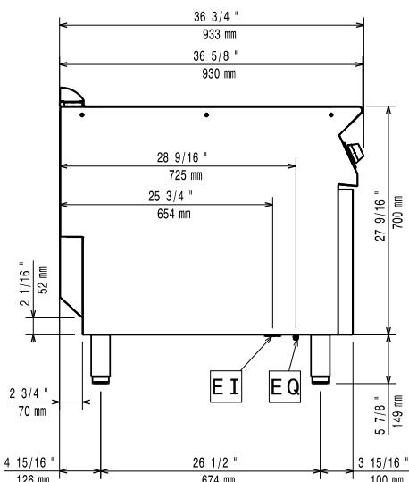
EI = Conexión eléctrica (energía)
